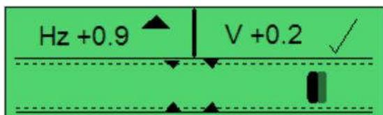
最初，同步窗口显示发电机与母排的差异，这里显示频率差为+0.9 Hz、电压差为+0.2 V。发电机频率太高了（箭头所示）需要降低。发电机电压也高，但是在同步设置允许的范围内（打勾所示）。
