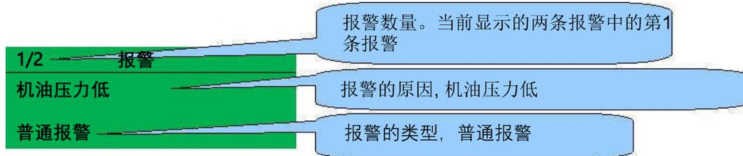
LCD 可显示多个报警，比如“冷却液温度高”，“紧急停机”和“低冷却温度报警”。这些将会自动按发生报警的顺序滚动显示，或者按**向上向下按钮**
