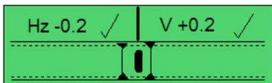
一旦发电机和母排同步完成，控制器立刻发出发电合闸信号使发电机负载开关合闸，发电机与母排并联。当同步状态被打破时，移动的光标超出相位角允许范围，控制器出现超出同步范围报警。
