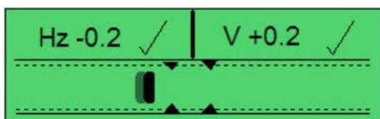
当频率和电压都调整到同步设置允许的范围内，相位角开始同步。移动的光标显示两者的相位角差异。发动机转速会自动调节改变相位角，直到光标移动到相位角允许范围的中间。
